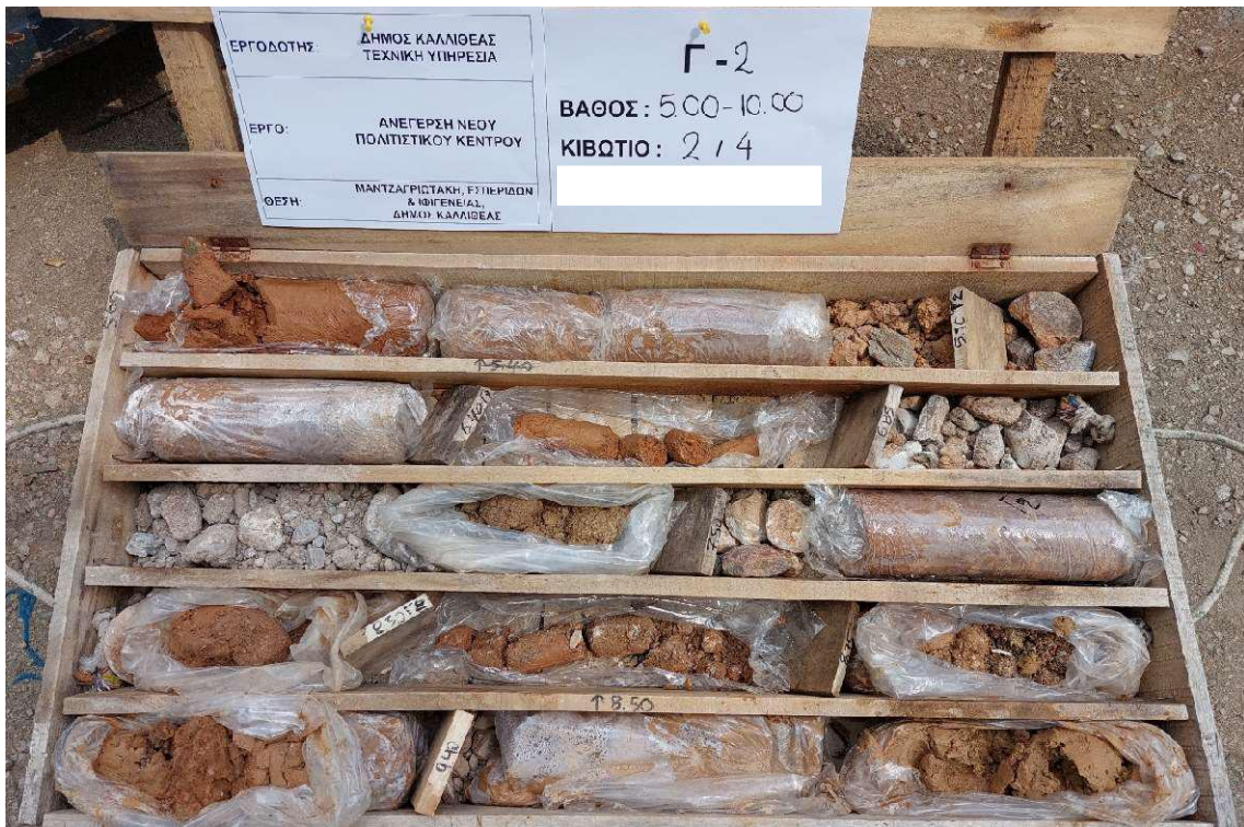
ΦΩΤΟΓΡΑΦΙΕΣ ΓΕΩΤΡΗΣΗΣ Γ-2 0.00 m – 10.00 m
