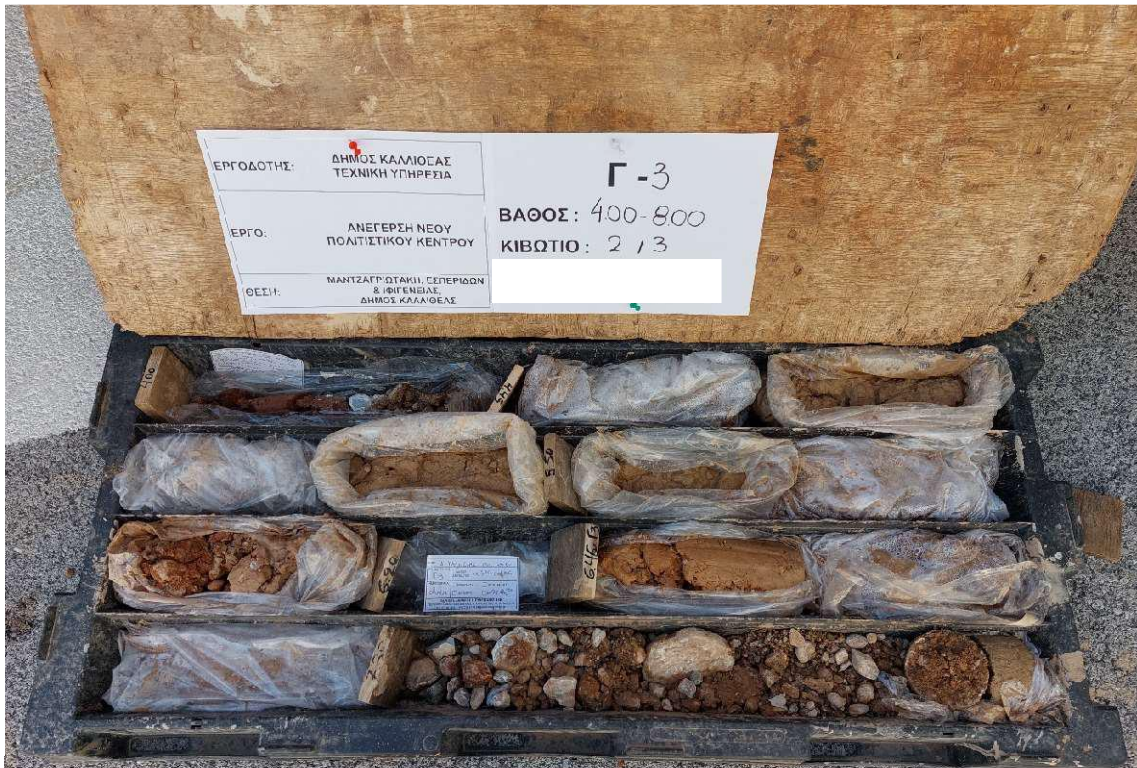
ΦΩΤΟΓΡΑΦΙΕΣ ΓΕΩΤΡΗΣΗΣ Γ-3 0.00 m – 8.00 m
